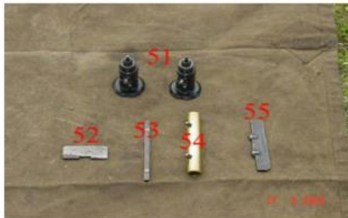
Fig 5 - Bloco de percussão e ferramentas da culatra
