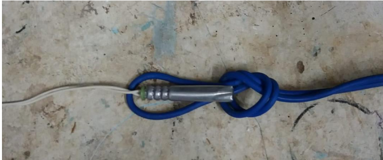
Fig. 5 – Chave de fogo com escorva elétrica
