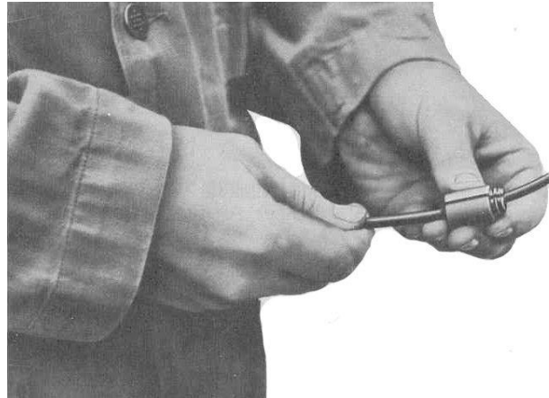
Fig. 2 – Colocação de um adaptador
