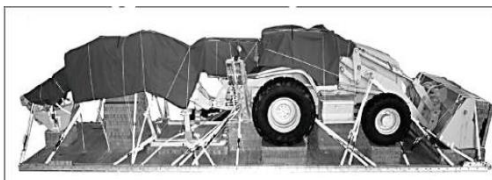
Fig. 2 Retroescavadora preparada para lançamento a baixa velocidade
