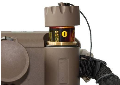
Figura 4 - Inserção da bateria
