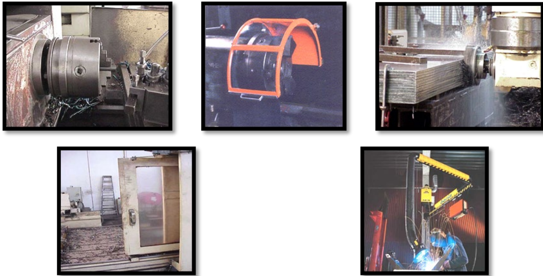
Fig. 21 – Riscos de projeção e emissão associados a operações com alguns equipamentos de trabalho e respectivas medidas de proteção
