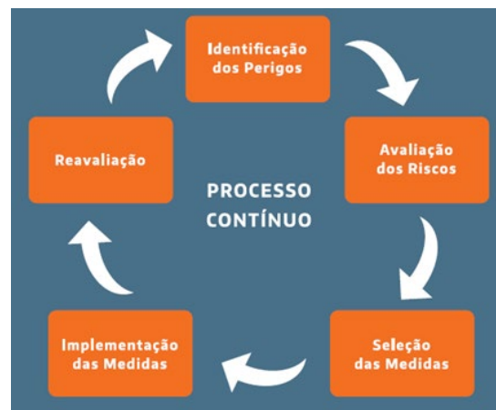
Fig. 5 – Processo iterativo da gestão da segurança de máquinas
