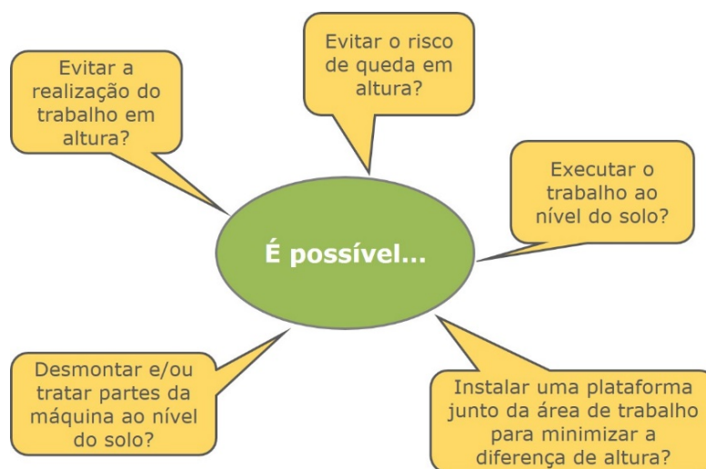
Fig. 28 – Processo de avaliação de riscos associados a uma operação que implica a realização de trabalhos em altura
