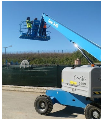
Fig. 37 – Plataforma elevatória de carro automotor de alcance variável
