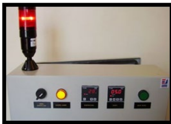
Fig. 23 – Exemplo de dispositivo de alerta luminoso
